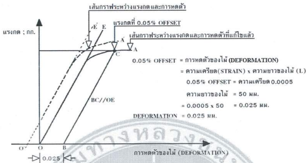
รูปที่ 3 กราฟแสดงความสัมพันธ์ระหว่างแรงกดและการหดตัวของไม้
