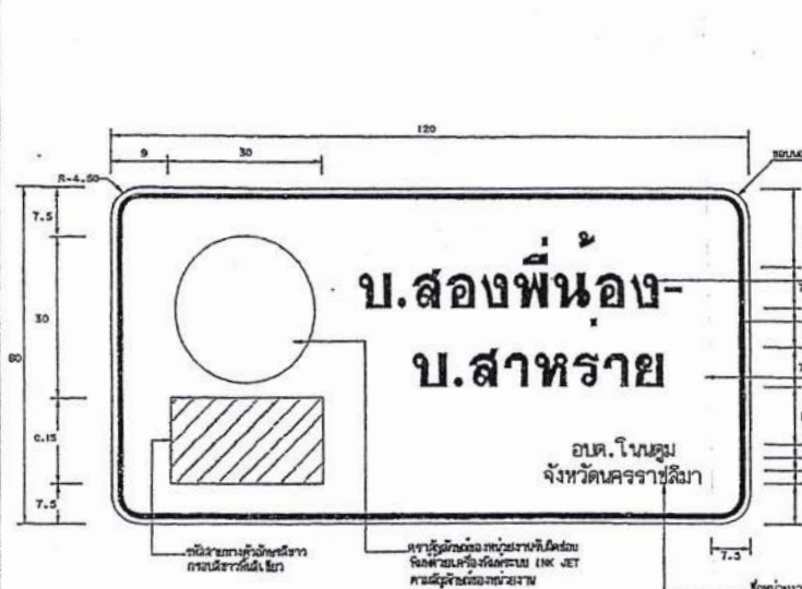
ป้ายหมายเลขวางหลวงท้องถิ่น น-1 (กรณีติดตั้งป้ายในเขตทางของทางหลวงท้องถิ่น) หน่วยเป็น เซนติเมตร
